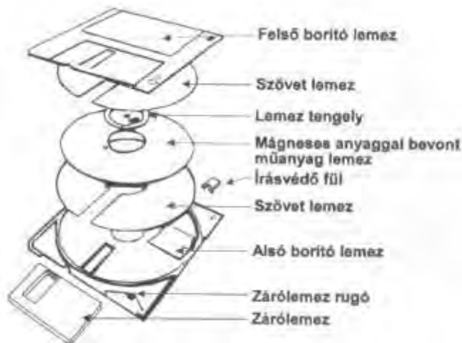
8.6. ábra: A 3,5" lemez felépítése
